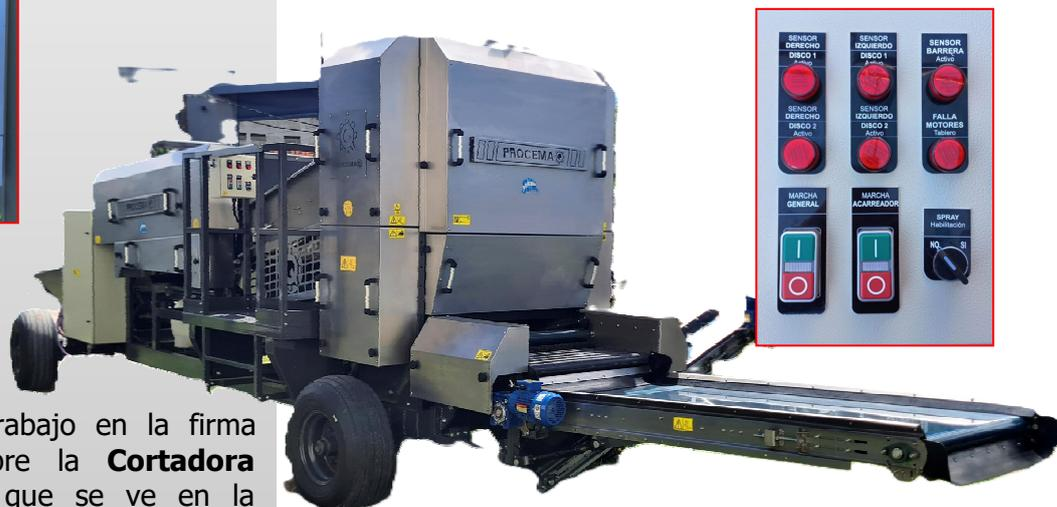
Un ejemplo del trabajo en la firma Procemaq es sobre la **Cortadora modelo PC800**, que se ve en la imagen. Este equipo contempla: los enclavamiento para el arranque de los motores, sistema de dosificación de productos, seguridad de equipo y de personas con switch de seguridad de operación de proceso, y las correspondientes Paradas de Emergencia.
